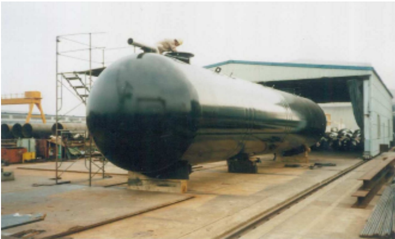
耐震性貯水槽
