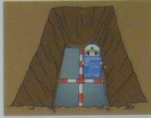
⑦ 基礎コンクリート 出来形検測 L=△△△ W=△△△ H=△△△
