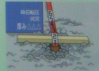
⑤ 基礎碎石 厚み確認
