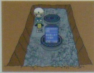
⑬ 埋め戻し完了、つき固め
