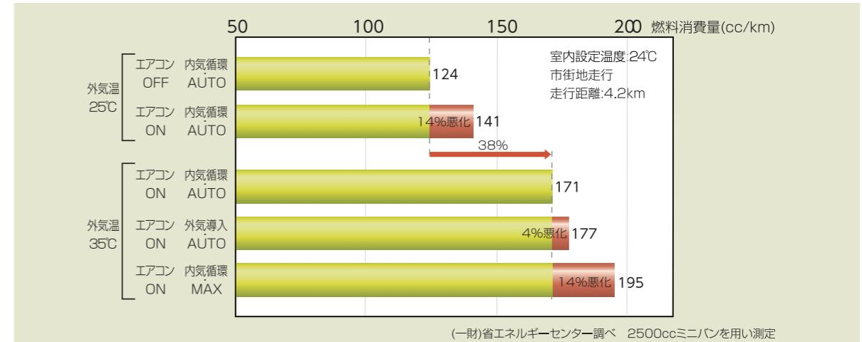
エアコンは、「A/C」スイッチONによる燃費悪化が大きいため、エアコンを使わない時は「A/C」スイッチをOFFにするようにしましょう。
