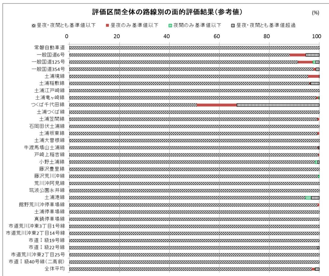
図 3-2-16 自動車騒音常時監視による環境基準適合状況 (平成 30 年度)
