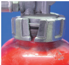
× キャップの破損
