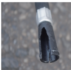
× ノズルの破損
