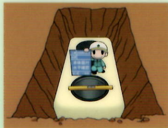
⑩ 本体据付、水平確認
