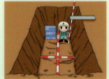
③ 床掘完了 L=△△△ W=△△△ H=△△△
