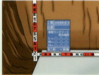
⑧ 基礎コンクリート 厚み確認 H=△△△
