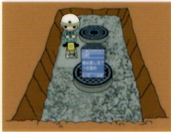
⑬ 埋め戻し完了、つき固め
