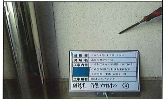
研修室外部 外壁 アクリルリシン③ 採取中
