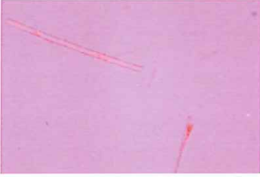
偏光顕微鏡法 (屈折率 n_D^{25^\circ\text{C}} 1.550 )
