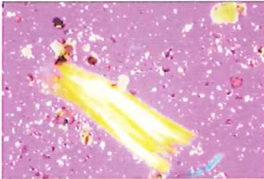
偏光顕微鏡法 (屈折率 n_D^{25^\circ} 1.550 )
